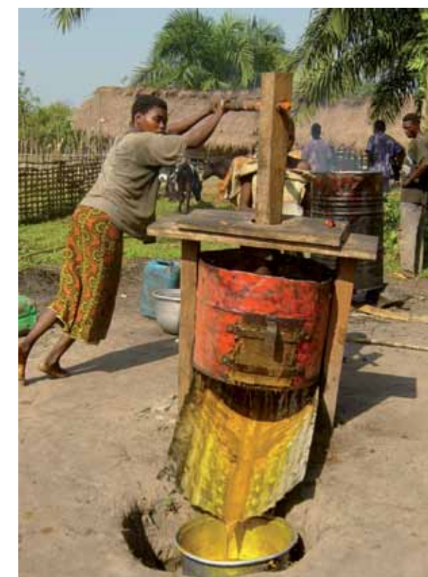
III.21.18. Femme extrayant l'huile de palme à l'aide d'un malaxeur-pressé artisanal. En arrière-plan, un fût dans lequel sont chauffés les régimes. (Photo CDI-Bwamanda/Heverlee, 2003.)
